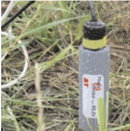
Medición de la humedad de la tierra
